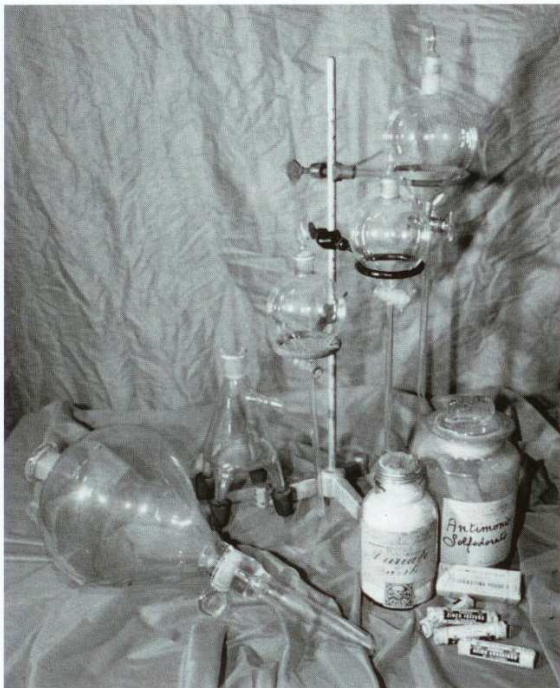
Fig. 8. Vetreria soffiata; sostegno con 3 imbutoi separatori; in primo piano, a sinistra «MUCCA» per la raccolta di frazioni di distillazione sotto vuoto e prodotti farmaceutici dei primi decenni del 1900.
