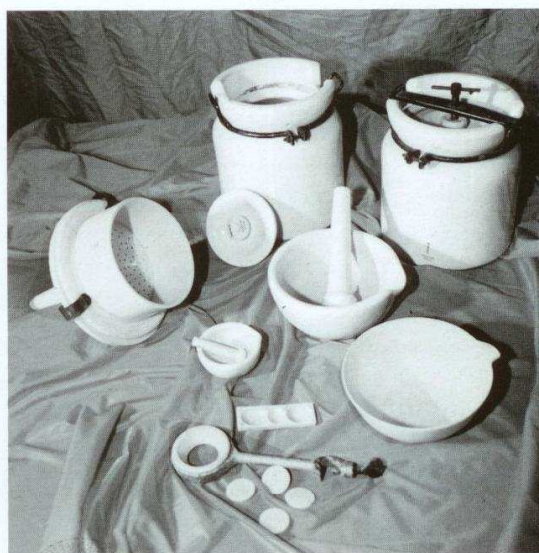
Fig. 6. Vari utensili in porcellana utilizzati per la preparazione di polveri; sullo sfondo 2 mortai per mulino a palle ed, a sinistra, imbuto con piastra filtrante.
