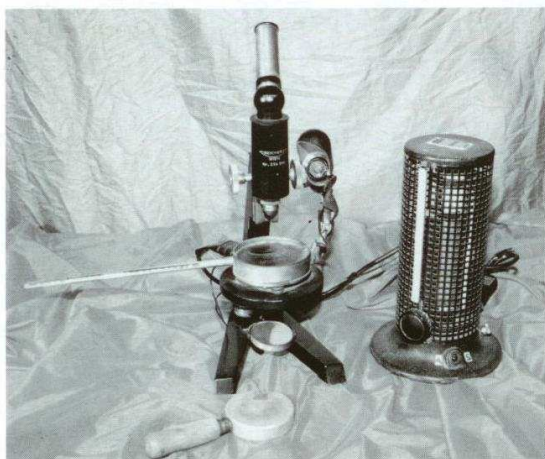
Fig. 5. Apparecchio per la determinazione del punto di fusione tipo KOFLER e relativa piastra di raffreddamento; n.i. 563.
